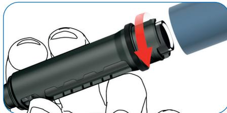
**5** Montez le porte-cartouche sur le corps du stylo dans lequel la tige a été repoussée en le tournant à 90 degrés, jusqu'à ce qu'il s'arrête. Fixez l'aiguille comme indiqué dans l'étape «Fixation de l'aiguille».
